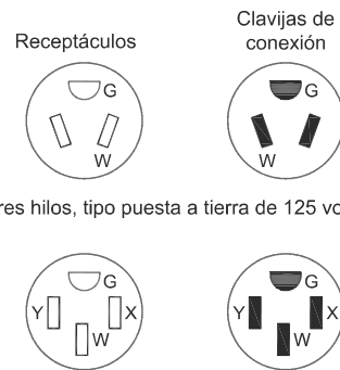
Tres polos y cuatro hilos, tipo puesta a tierra de 125/250 volts y 50 amperes
