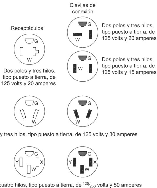
Figura 551.46(C). Configuraciones de receptáculos y clavijas de conexión del tipo puesta a tierra, utilizadas con los cordones de alimentación de los vehículos recreativos y en los lotes para vehículos recreativos.
